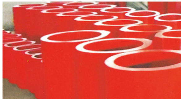
高压线圈浇注体 HV winding casted part
